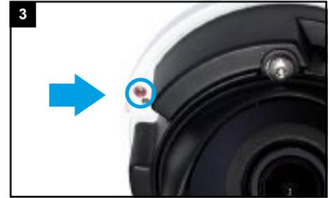
Ziehen Sie die kleine Inbus-Schraube an der Seite fest an, damit sich die Kamera nicht mehr von der Montageplatte löst. Überprüfen Sie den festen Halt der Kamera.
