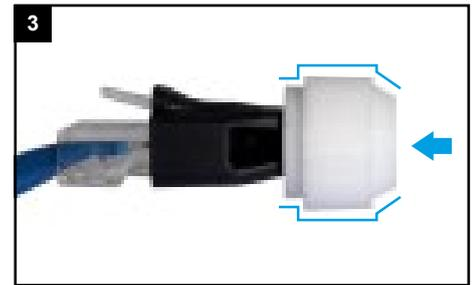
Kabel mit der Kabeleinführ-Hilfe durch die Dichtung pressen. Achten Sie darauf, die Dichtung richtig herum zu verwenden.
