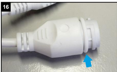
Die Dichtung muss vollständig aufliegen.
