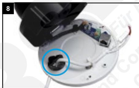
Prüfen Sie, ob die Dichtungen korrekt aufliegen, sodass keine Feuchtigkeit in die Kamera gelangen kann.
