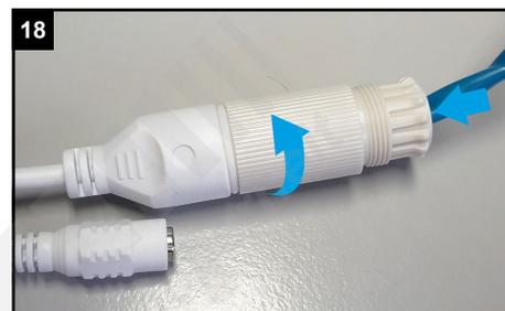
Schieben Sie den Schraubbolzen zum Kamerakabel und schrauben Sie diesen fest.
