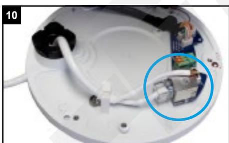
Stecken Sie das Netzkabel und bei Verwendung des mitgelieferten Anschlusskabels auch den 12V DC Stecker in die dafür vorgesehenen Anschlüsse.
