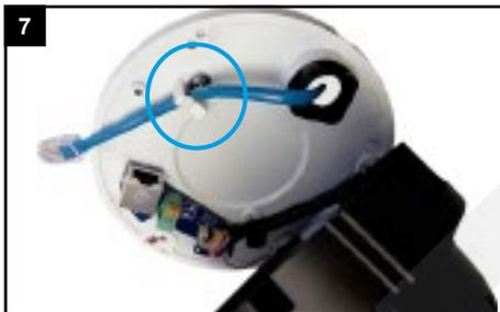
Setzen Sie das Kabel in die Kabelführung.
