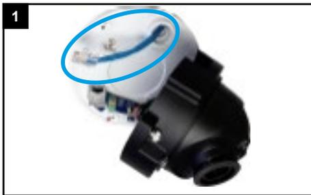
Ziehen Sie das Kabel durch die Kabelzufuhr in die Kamera hinein.
