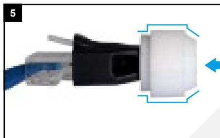
Kabel mit der Kabeleinführ-Hilfe durch die Dichtung pressen. Achten Sie darauf, die Dichtung richtig herum zu verwenden.
