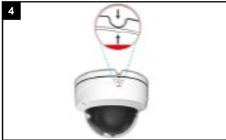
4 Haube wieder aufsetzen. Die Kerbe an der Haube muss bündig mit der seitlichen Kabelzufuhr sein.
