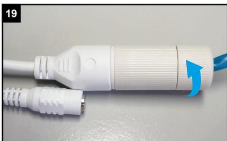
Schrauben Sie die Verschraubung feste an.
