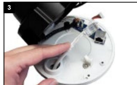
Führen Sie die Verkabelung mit der Kabeleinführ-Hilfe durch die Dichtung von Außen in die Kamera.
