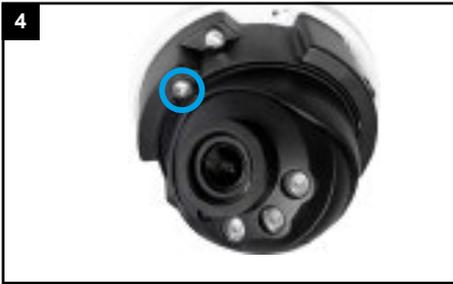
Lösen Sie die hier abgebildete Schraube, um die Fixierung für das Objektiv zu lösen.
