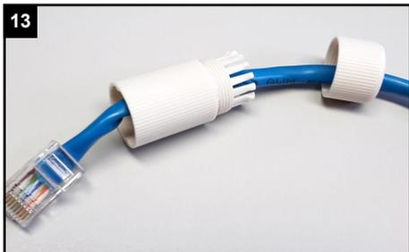
Verschraubung und Schraubbolzen nacheinander über das Kabel ziehen, mit dem Sie die Kamera verbinden möchten.
