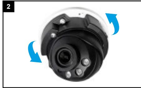
Befestigen Sie anschließend mit einer Drehung die Kamera an die Montageplatte beziehungsweise am Wandhalter.
