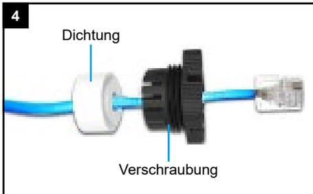
Führen Sie die Verkabelung anschließend auch durch auch durch die Verschraubung.
