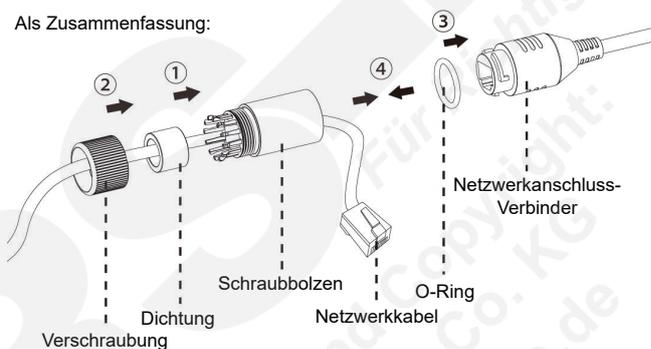
1. Verschraubung, Dichtung und Schraubbolzen über das Kabel ziehen.
